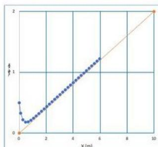
L'application d'une correction proportionnelle réduit l'erreur mais laisse une erreur de traînée.
