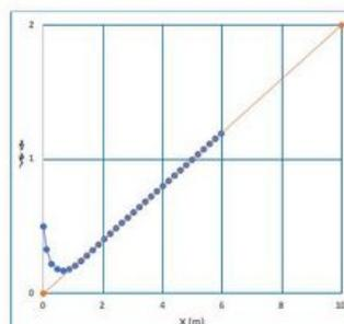
L'ajout d'un terme intégral à la correction permet de supprimer l'erreur de traînée.
